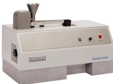
**Измерение :** размер и форма частиц
