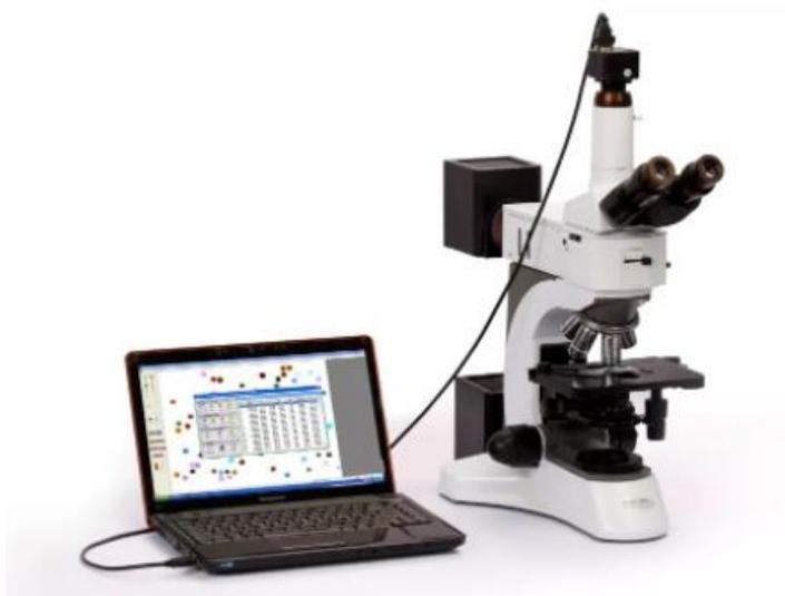
**Измерение :** размер и форма частиц
