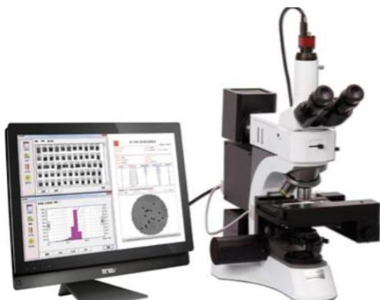
Анализатор частиц BeVision M1 представляет собой автоматическую систему сканирования изображений для анализа чистоты фильтровальной бумаги. Оснащенный металлургическим микроскопом, программируемым моторизованным столиком, функцией автофокусировки и ПЗС-камерой высокого разрешения, анализатор частиц BeVision M1 может захватывать и распознавать каждую отдельную частицу, автоматически объединяя изображения в большую панораму.
