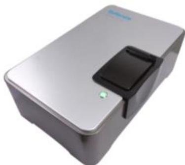
**Измерение :** размер частиц, дзета потенциал, молекулярная масса
