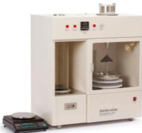
Это не автоматическая версия прибора PowderPro A1. Он позволяет производить те же измерения, что и PowderPro A1, но при помощи ручных манипуляций оператора.
