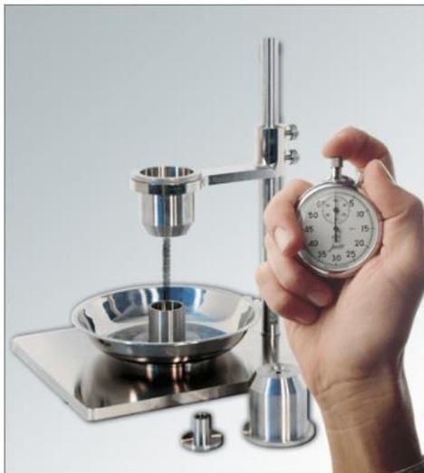
Взвесьте 50 г образца (с точностью до  $\pm 0,1$  г) и положите его на гладкую бумагу. Одним указательным пальцем заблокируйте выходное отверстие воронки, другой рукой держите секундомер, высыпьте 50 гр. образца с бумаги в воронку, запустите время секундомера, убрав палец с отверстия воронки. Остановите отсчет времени сразу после того как высыпется образец и запишите зафиксированное время (с точностью до 0,2 с).
